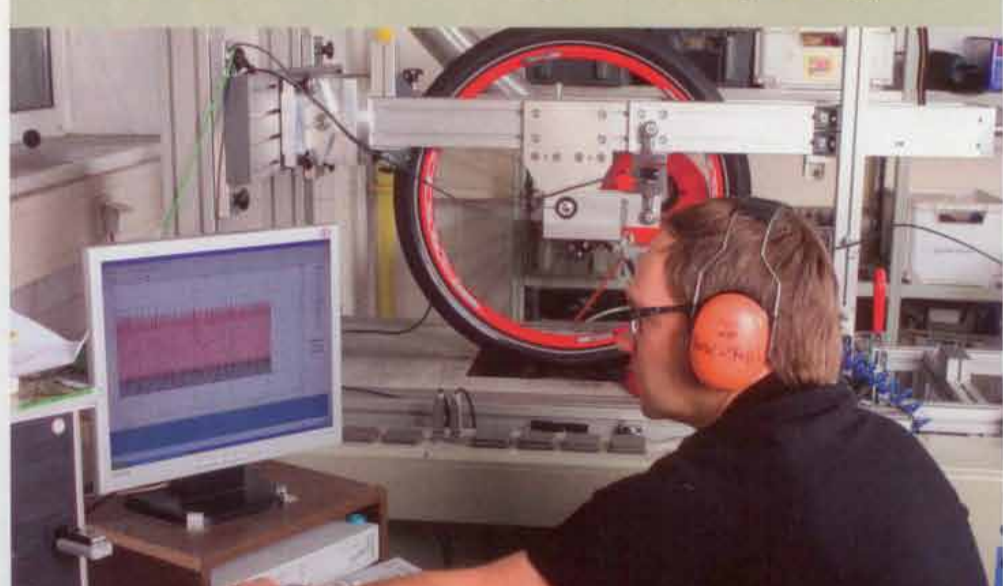
Keine Gnade auf dem Prüfstand: Drei Mal 1000 Bremsungen pro Belag sind die Basis des Verschleißtests.
